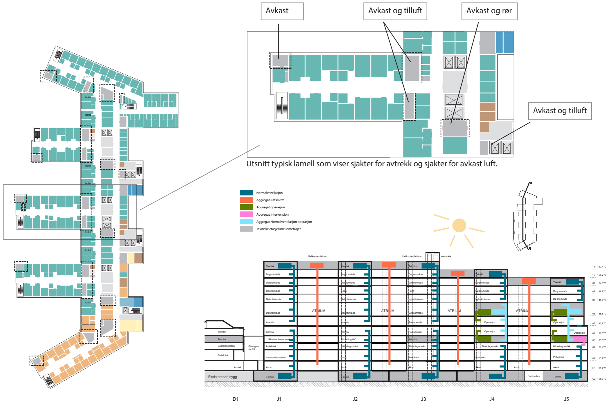
Typisk etasje med sjakter for ventilasjon markert
