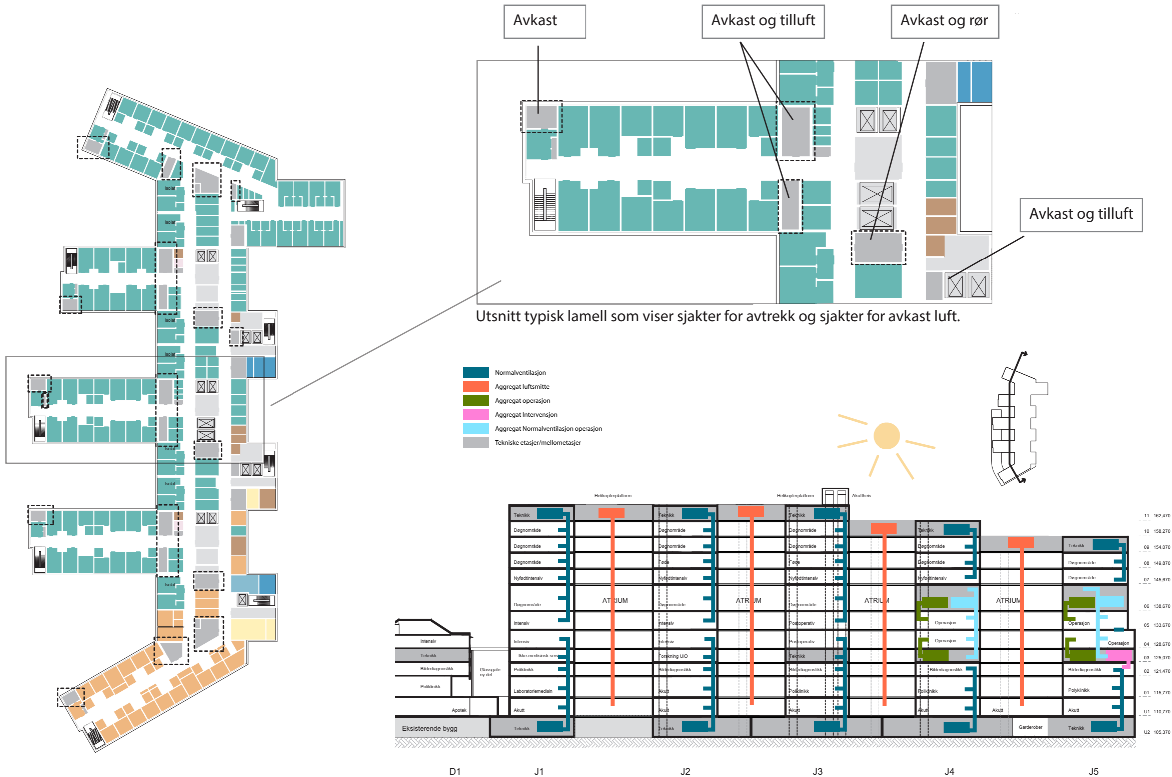
Typisk etasje med sjakter for ventilasjon markert
